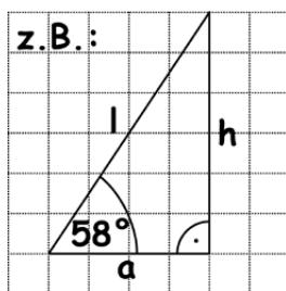
$$\sin 58^\circ = \frac{5,8 \text{ m}}{l}; \quad l = 5,8 \text{ m} : \sin 58^\circ;$$
